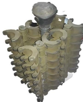
(b) Odlewy wykonywane w pakiecie w procesie skorupowym
