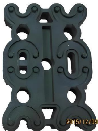
(a) Jednoczęściowy rdzeń do procesu skorupowego
