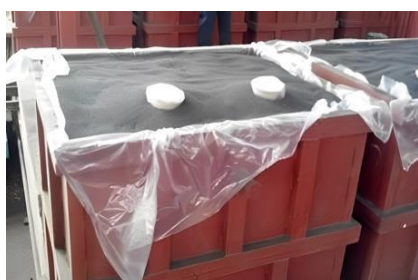
(b) Formowanie z piaskiem ceramicznym
