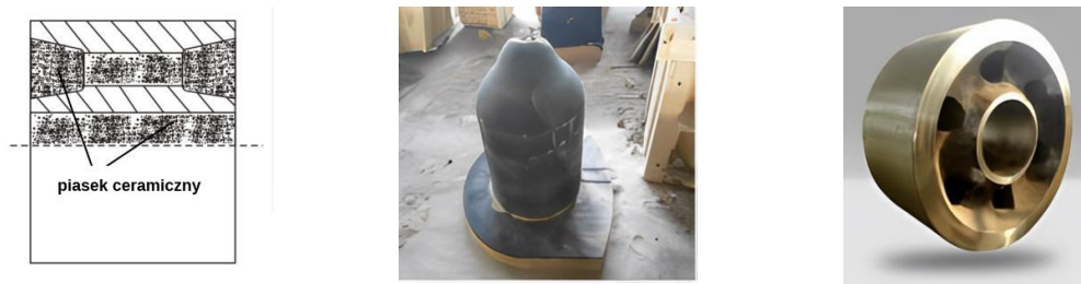
(a) Miejsce wypełnienia piaskiem ceramicznym (b) Piasek ceramiczny na powierzchni rdzenia (c) Rolka podporowa (staliwo)
