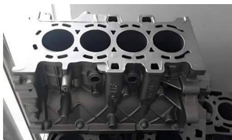
(c) Blok cylindrów wykonany w procesie Lost Foam
