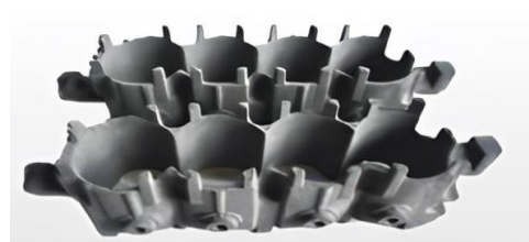
(b) Rdzeń płaszczki wodnego bloku cylindrów
